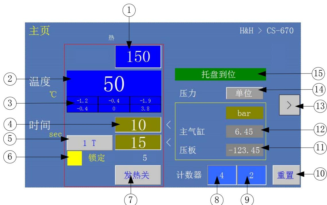
1. 加热温度设定按键，按钮上直接显示设定温度。点击此按钮会弹出数字键盘，可以进行温度设定。
