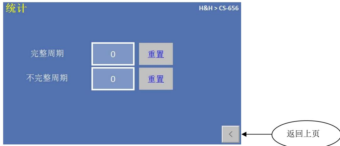
此页面显示完整的压板下压动作的循环次数及不完整的循环次数（因曾经按动“取消”按键或触发安全杠）。按下各周期右方的“重置”键，均能重置该周期的循环次数归零。这项功能可避免操作员为了提高生产数而扰乱正常的操作。
